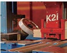
ドイツのフンデガー社製「K2i」を導入し、これまではどんな加工機でも対応不可能だった3次元特殊加工に対応しました。各ユニットで対応できる仕口・継手形状の自由度が高い為、通常の垂直・直角以外の斜め材や登り材はもちろんのこと、それらを組み合わせて3次元の納まりにも対応できます。
