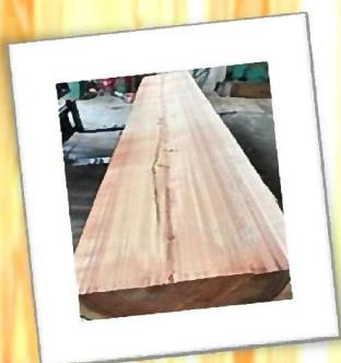
建築材料としては、カビに強く調湿作用があり、断熱性が高いといった特徴があります。桧に比べると資源量が多く、収穫までの時間がからないことから、リーズナブルで、コストパフォーマンスの高い素材として扱われています。構造材では主に建物を支える「柱」に利用されます。
